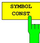
Der Softkey *SYMBOL CONST* selektiert die Auswertung des Constellation-Diagramms auf Symbolebene. Die Anzeige ist normiert auf die Quadratwurzel der mittleren Symbolleistung. Die Auswertung der Symbole erfolgt für den gewählten Kanal (Softkey *SELECT CHANNEL*) und den gewählten Slot (Softkey *SELECT SLOT*). Somit berücksichtigt diese Auswertung Ergebnisse eines Kanals für einen Slot. Zur Orientierung wird der Einheitskreis der Darstellung überlagert.
