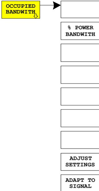
Der Softkey *OCCUPIED BANDWIDTH* aktiviert eine Messung der vom Signal belegten Bandbreite in ausgewählten Slots. Bei dieser Messung wird die Bandbreite bestimmt, in der – im Grundzustand – 99 % der Signalleistung zu finden sind. Der prozentuale Anteil der Signalleistung, der in die Bandbreitenmessung einbezogen werden soll, kann verändert werden. Die Bandbreite sowie die Eckfrequenzen für die Messung werden im Marker-Info-Feld in der rechten oberen Ecke des Displays angezeigt.
