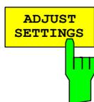
Der Softkey *ADJUST SETTINGS* optimiert automatisch die Geräteeinstellungen des Analysators für die gewählte Leistungsmessung.
