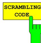
Der Softkey *SCRAMBLING CODE* erlaubt die Eingabe des Scrambling Codes der Basisstation. Der Scrambling Code wird dezimal eingegeben.
