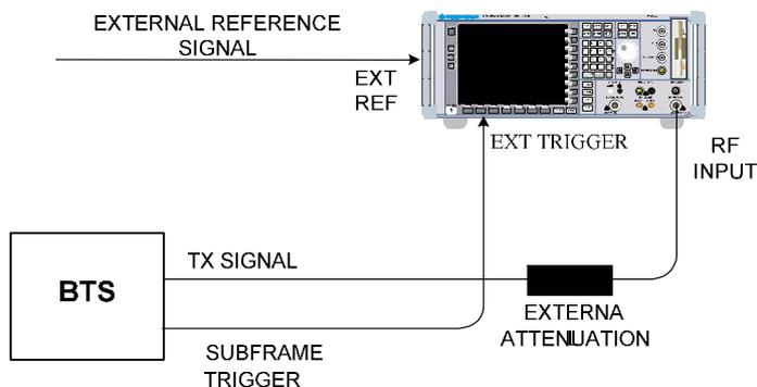
Bild 3-1 BTS Messaufbau
