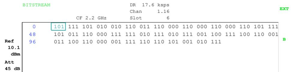
Bild 5-21 Demodulierte Bits für einen Kanal mit 8PSK-Modulation
