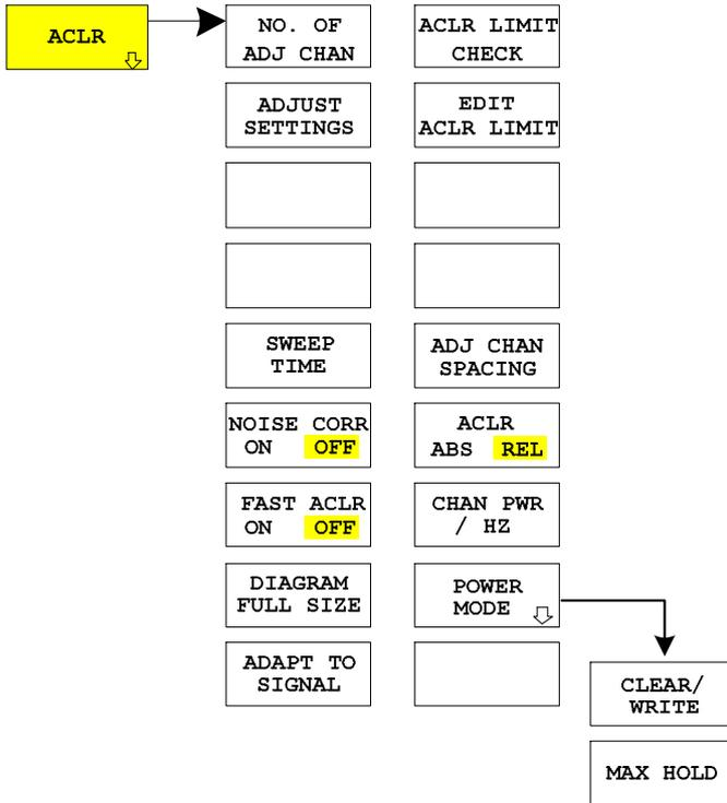
Der Softkey *ACLR* (Adjacent Channel Leakage Power Ratio) aktiviert die Messung der Nachbarkanalleistung. Die Einstellungen und Grenzwerte werden der in der TD-SCDMA-Spezifikation definierten ACLR-Messung entnommen.
