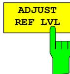
Der Softkey *ADJUST REF LVL* passt den Referenzpegel des Analysators an die gemessene Kanalleistung an. Damit wird sichergestellt, dass die Einstellungen der HF-Dämpfung und des Referenzpegels optimal an den Signalpegel angepasst werden, ohne dass der Analysator übersteuert wird oder die Dynamik durch zu geringen Signal-Rauschabstand eingeschränkt wird.
