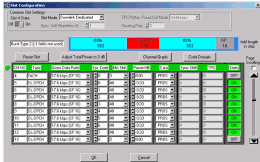
Bild 2–5 WinIQSIM – Kanaleinstellungen in den Slots 4–6
