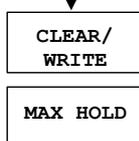
Das *POWER MODE* Untermenü erlaubt den Power Modus zwischen dem normalen (*CLEAR/WRITE*) und dem *MAX HOLD*-Modus umzuschalten. Im *CLEAR/WRITE* Modus werden die Kanalleistung und die Nachbarkanalleistungen direkt von der aktuellen Tracekurve ermittelt. Im *MAX HOLD*-Modus werden die Leistungen noch immer aus der aktuellen Tracekurve ermittelt, jedoch werden sie über einen Maximum Algorithmus mit dem vorangegangenen Wert verglichen. Der größere Wert bleibt erhalten.
