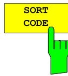
Der Softkey *SORT CODE* sortiert die Kanaltabelle in der Code-Ordnung. Es werden zunächst alle Midambles aufsteigend nach ihrem Midamble-Shift sortiert. Ihnen folgen die Codekanäle, die aufsteigend nach Spreading-Faktoren und innerhalb gleicher Spreading-Faktoren aufsteigend nach Codenummern sortiert werden.
