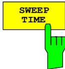
Der Softkey *SWEEP TIME* aktiviert die Eingabe der Sweepzeit. Mit dem RMS-Detektor führt eine längere Sweepzeit zu stabileren Messergebnissen. Diese Einstellung ist identisch zur Einstellung *SWEEP TIME MANUAL* im Menü *BW*.
