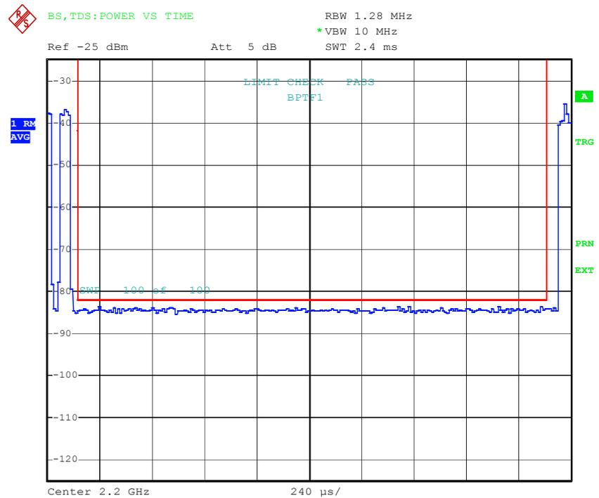
Bild 5-5 Messung der Signalleistung über der Zeit
