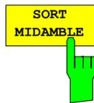
Der Softkey *SORT MIDAMBLE* sortiert die Kanaltabelle in der Midamble-Ordnung. Es werden nach jeder Midamble die zugehörigen Codes aufgeführt.
