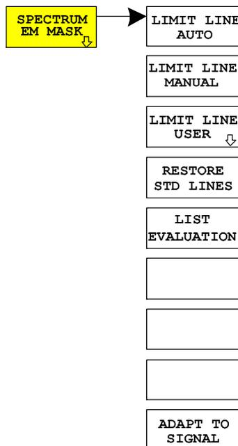
Der Softkey *SPECTRUM EM MASK* (Spectrum Emission Mask) startet die Bestimmung der Leistung ausgewählter Slots des TD-SCDMA-Signals in definierten Offsets vom Träger und vergleicht die Leistungen mit der von der TD-SCDMA-Spezifikation vorgegebenen Spectrum Emission Mask im trägernahen Bereich zwischen -4 MHz und 4 MHz.
