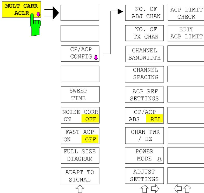
Der Softkey *MULT CARR ACLR* (Multi Carrier Adjacent Channel Leakage Power Ratio) aktiviert die Messung der Nachbarkanalleistung für mehrere Trägersignale .
