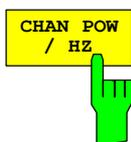
Der Softkey *CHAN PWR / HZ* schaltet zwischen der Messung der Gesamtleistung im Kanal und der Messung der Leistung im Kanal bezogen auf 1 Hz Bandbreite um.
