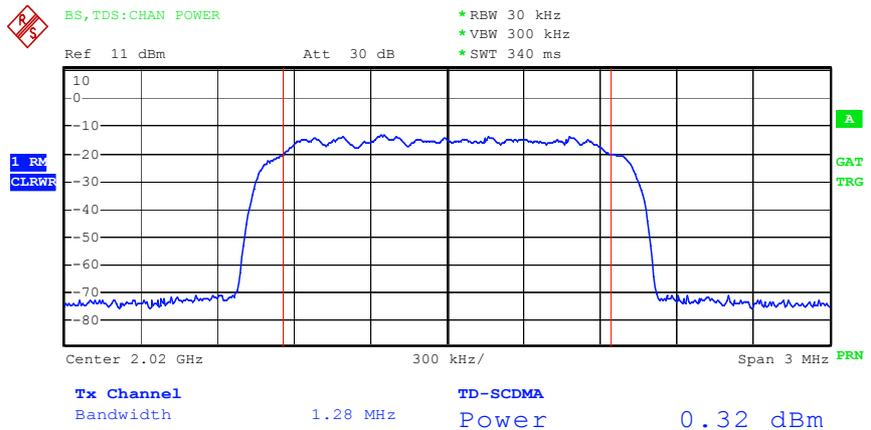
Bild 5-1 Messung der Leistung über 1.6 MHz Bandbreite.
