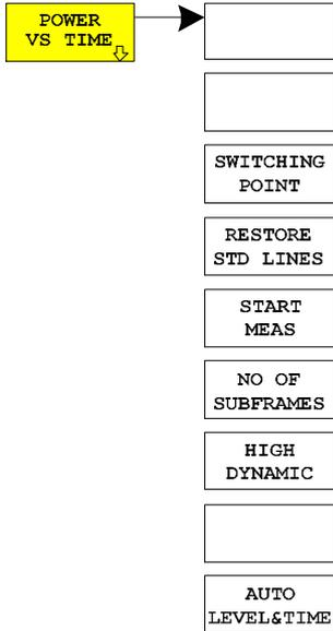
Der Softkey *POWER VS TIME* aktiviert die Messung der Signalleistung über der Zeit. Bei dieser Messung wird der Subframestart bestimmt und die Signalleistung über der Zeit mit der von der TD-SCDMA-Spezifikation vorgegebenen Transmit ON/OFF Zeitmaske verglichen. Es wird der Zeitabschnitt vom Ende des Slots 0 bis zum Switching-Point dargestellt.
