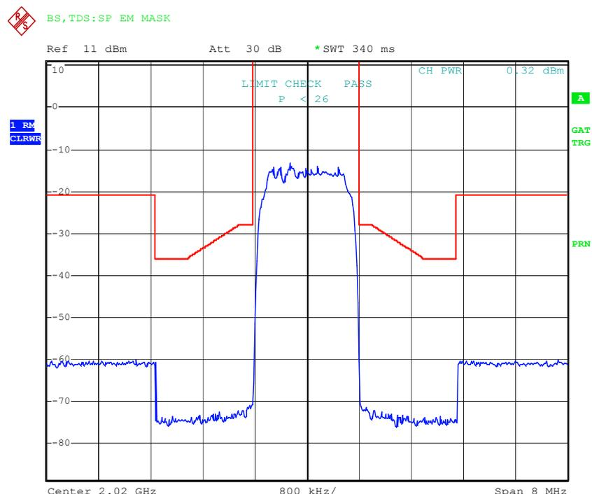
Bild 5-3 Messung der Spectrum Emission Mask (3GPP)
