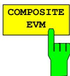
Der Softkey *COMPOSITE EVM* wählt die Auswertung der Error-Vector-Magnitude (EVM) über das Gesamtsignal (Modulation Accuracy).
