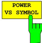
Der Softkey *POWER VS SYMBOL* selektiert die Auswertung Power-versus-Symbol. Die Auswertung gibt die absolute Leistung in dBm an jedem Symbolzeitpunkt für den gewählten Kanal (Softkey *SELECT CHANNEL*) im gewählten Slot (Softkey *SELECT SLOT*) aus. Somit berücksichtigt diese Auswertung Ergebnisse eines Kanals für einen Slot.
