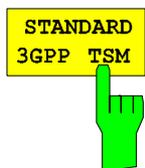
Der Softkey *STANDARD* ermöglicht die Umschaltung zwischen den Normen 3GPP und TSM. Diese Umschaltung betrifft zur Zeit nur die Spectrum Emission Mask.
