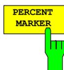
Bei aktiver CCDF-Funktion erlaubt der Softkey *PERCENT MARKER* die Positionierung von Marker 1 durch Eingabe einer gesuchten Wahrscheinlichkeit. Damit lässt sich auf einfache Weise die Leistung ermitteln, die mit einer vorgegebenen Wahrscheinlichkeit überschritten wird.
